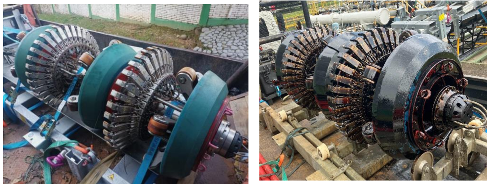
*La imagen muestra la herramienta inteligente inercial-geométrica corrida en el tramo El Porvenir – Miraflores.
